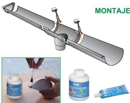
MONTAJE CON JUNTA
