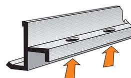
EL PERFIL no es autoportante, se soluciona con una correcta aplicación (relleno total con hormigón de la parte inferior del marco, tal como se aconseja, debe efectuarse algún agujero en el batiente para asegurarse que el relleno ha sido total y correcto).
