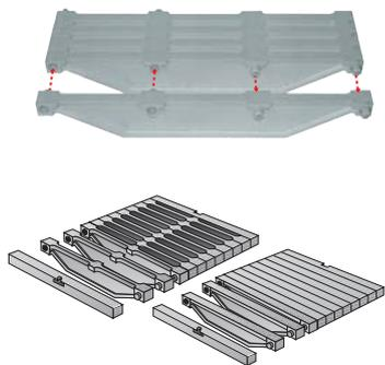
El además presenta otra gran innovación, la modularidad. Esta se realiza gracias al perno de anclaje situado sobre los elementos que hacen la función de unión de las piezas, creando una estructura no necesariamente rígida pero flexible, para adaptarse mejor a la superficie de apoyo.
