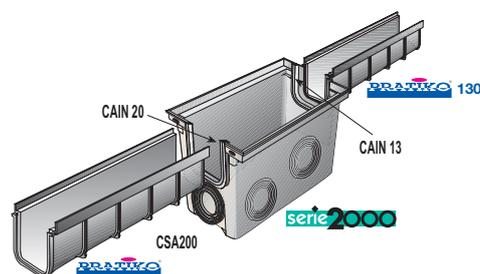
3) Montaje del **PRATIKO**. En este ejemplo se muestra la posibilidad de entrar en una canaleta de 130 y salir con una de 200.
