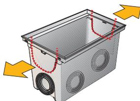
1) Rotura del impronta para introducción del adaptador **PRATIKO**
