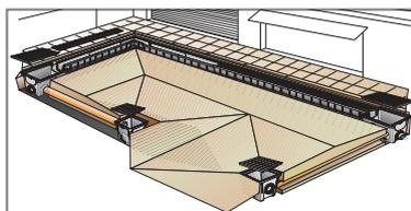
La arqueta rectangular PZR3050 **serie 2000** tiene una característica especial que consiente la puesta en obra sea como una arqueta normal o como integración del sistema de canaletas con rejilla **PRATIKO**, el acoplamiento del canal 130 y 200 en la arqueta se realiza con el adaptador en PVC CAIN.
