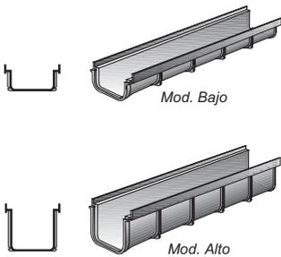
En cambio este modelo tiene un ancho considerable para ser utilizado en recogidas y canalizaciones de agua para instalaciones deportivas, entradas de garage y locales.
