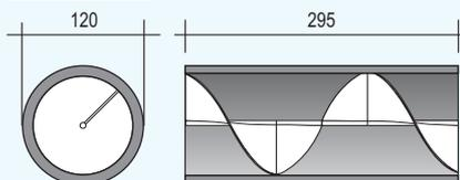
Para agujeros de ventilación (min. cm. 30) con tubo Ø mm. 125 (espesor máximo de 2,5 mm)
