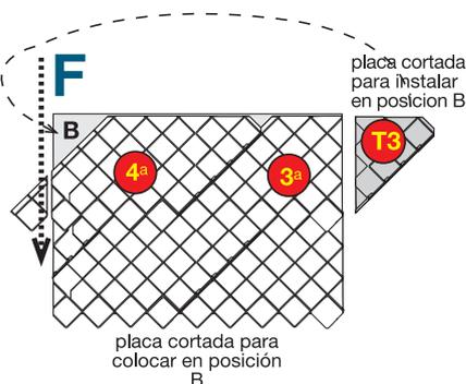
placa cortada para instalar en posición B
