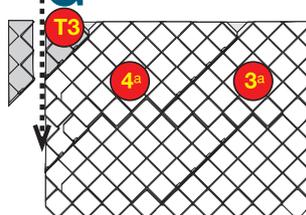
colocación de la placa T3 y corte de remate
