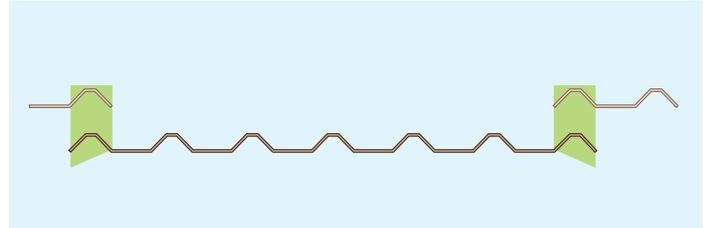
La placa EuroGrec, gracias a las características dimensionales de las ondas externas, puede ser colocada independientemente tanto de izquierda a derecha como de derecha a izquierda.
