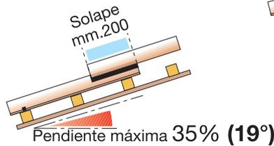
**COLOCACIÓN SEGÚN LA DIRECCIÓN DEL VIENTO**
