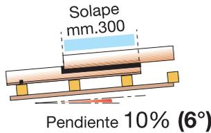
Se recomienda, en caso de mayor pendiente de los faldones, variar el solape en función de la inclinación, para evitar que, en caso de lluvias de intensidad excepcionales y de fuertes vientos en dirección de la cumbre, el agua pueda ascender por los solapes.
