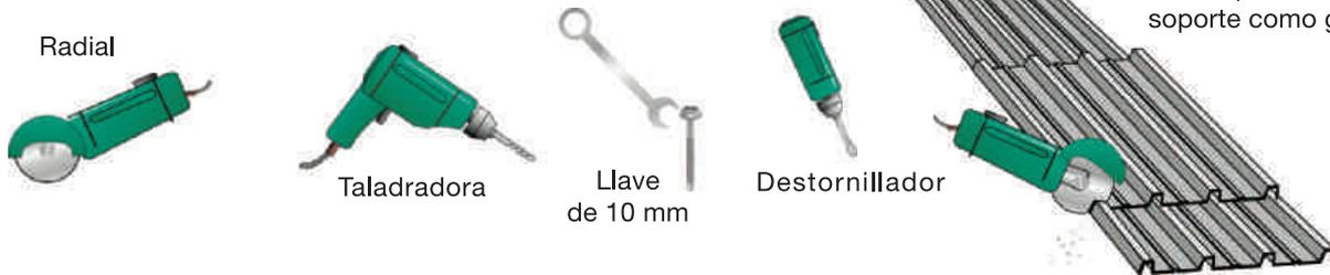
Tanto en el caso de que la placa esté colocada en el suelo, como que ya esté posicionada en la estructura de soporte, se aconseja utilizar un trozo de placa con corte original o un soporte como guía para el mejor corte.
