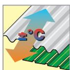
Los efectos causados por los cambios de temperatura, pueden provocar problemas a la cubierta, a la estructura portante y a los elementos de fijación. Las placas **COVER-LIFE** tienen un excelente comportamiento térmico, garantizando una excelente estabilidad dimensional, incluso en presencia de importantes variaciones térmicas, gracias a su bajo coeficiente de dilatación térmica ( 0,042mm x m x °C para las placas industriales y 0,052 mm x m x °C para las placas civiles).
