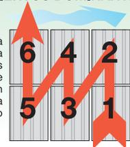
La placa se tendrá que girar 180° para mantener inalteradas las características de la superposición dependiendo de la dirección del viento predominante.
