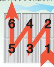
La placa se tendrá que girar 180° para mantener inalteradas las características de la superposición dependiendo de la dirección del viento predominante.
