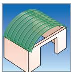
La cubierta, además de faldón plano, puede ser de diferentes formas (Cúpula, bóveda, etc).
